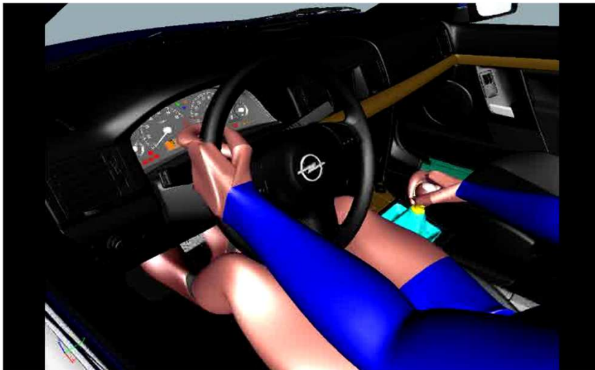
Ergonomie-Untersuchung mit Menschmodellen Quelle: Adam Opel AG
