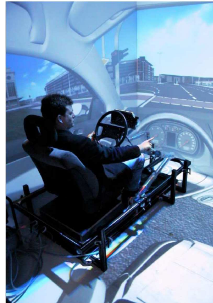
Sichtbarkeitsüberprüfung von Straßensituation, Interieur und Instrumenten.
